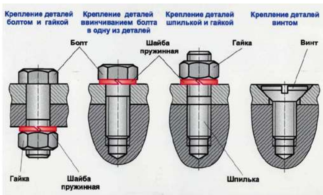
Рисунок 3. Основные типы резьбовых соединений:
