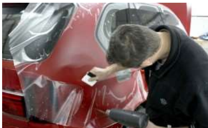
Рис. 2. Защитные пленки от коррозии
