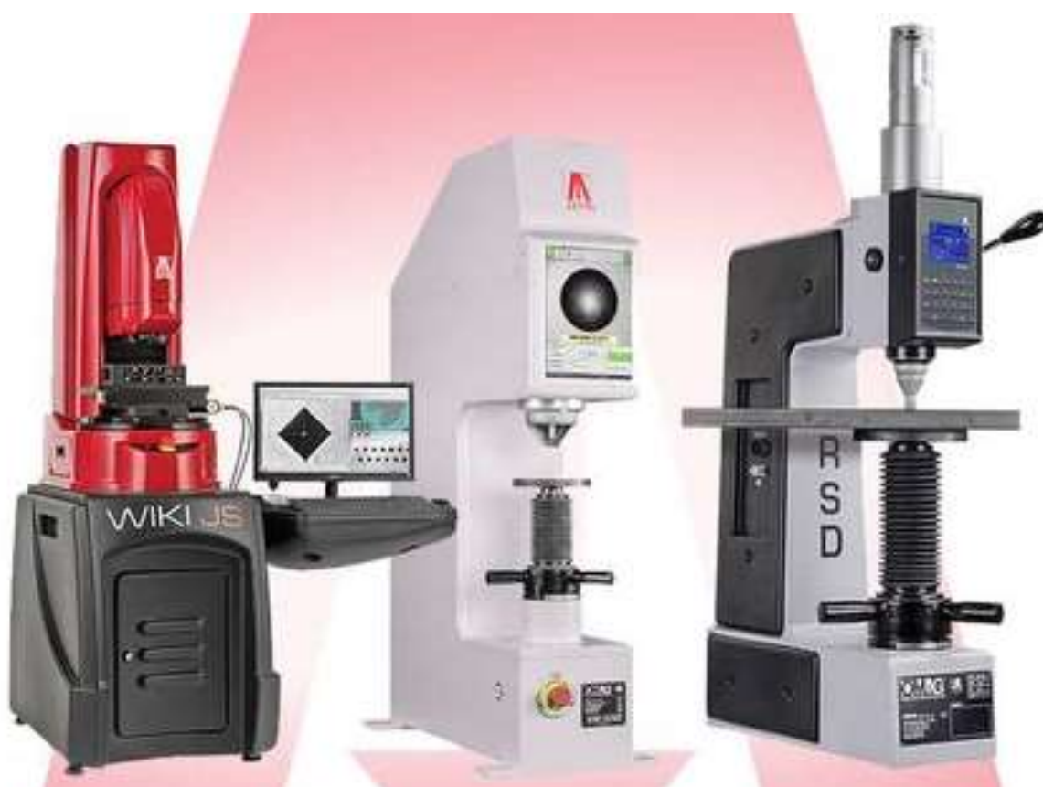
Рис.1. Твердомеры: Виккерс Роквелл Бринелль
