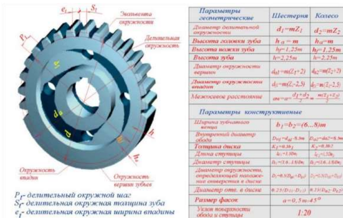
Рисунок 5. Геометрические параметры зубчатых колес
