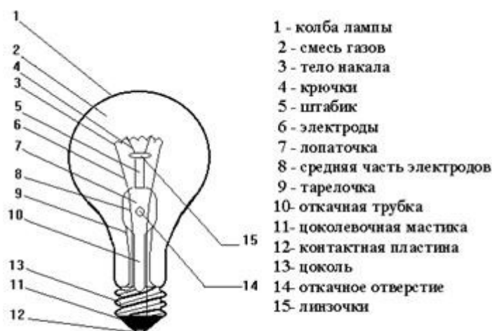
Рис. 3. Устройство лампы накаливания
