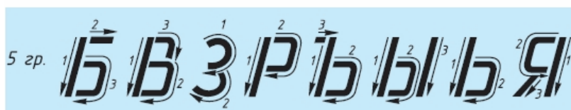
Рисунок 13. Начертание букв чертежного шрифта
