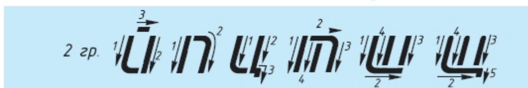
Рисунок 14. Начертание букв чертежного шрифта
