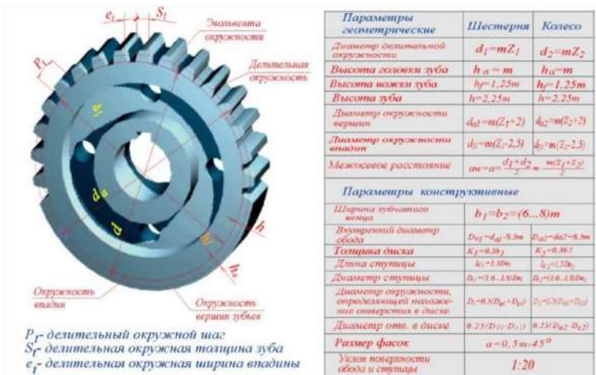
Рисунок 5. Геометрические параметры зубчатых колес
