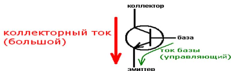
Она заключается в следующем: между эмиттером и коллектором течет сильный ток (ток коллектора), а между эмиттером и базой — слабый управляющий ток (ток базы). Ток
