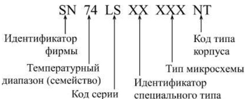
Каждая микросхема серий семейства 74 имеет свое обозначение, и система обозначений отечественных серий существенно отличается от принятой за рубежом.
