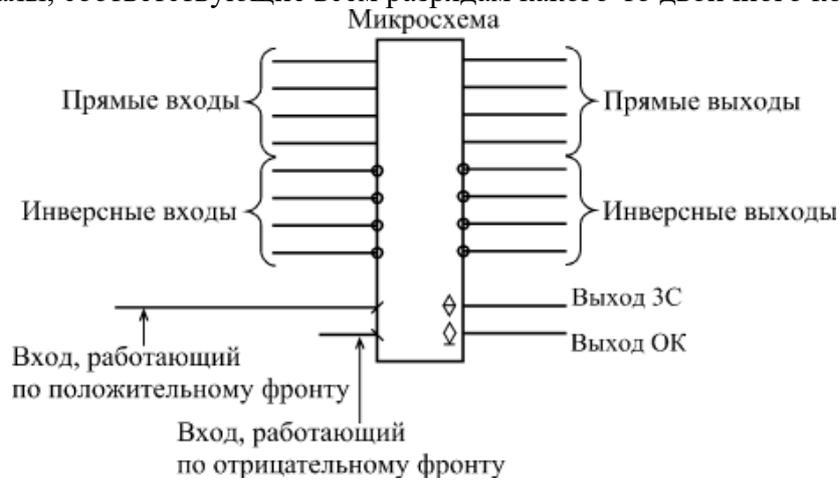
Рис. 2. Обозначение входов и выходов
