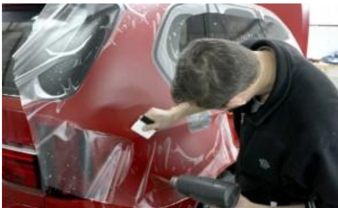
Рис. 2. Защитные пленки от коррозии
