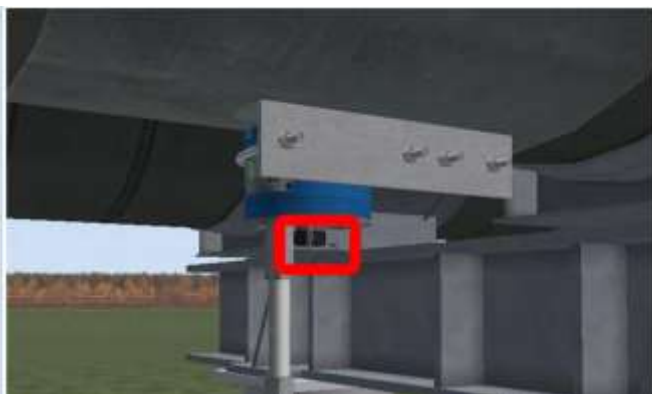
Рисунок 1. Крышка на дата-логгере.
