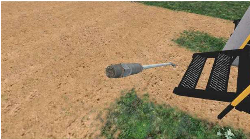
Рисунок 4. Установка "образцы свидетеле коррозии" (забитые песком)
