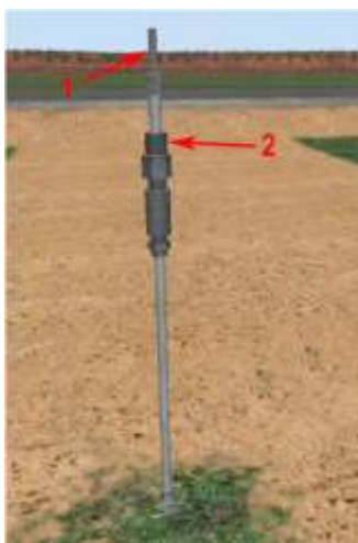
Рисунок 4. Установка "образцы свидетели коррозии" (забитые песком)
