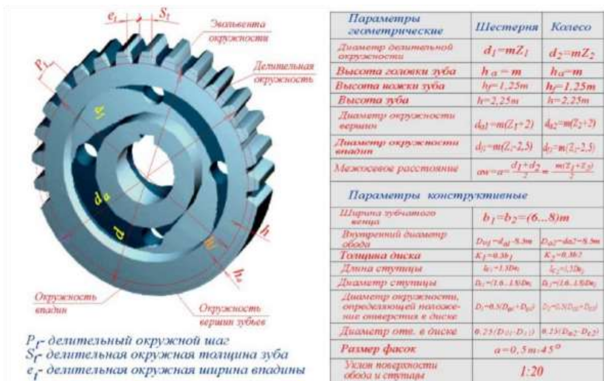
Рисунок 5. Геометрические параметры зубчатых колес
