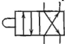
а) гидрораспределитель четырехлинейный двухпозиционный;
