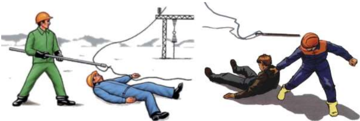
Рис. 3. Способы освобождения пострадавшего при напряжении выше 1000 В
