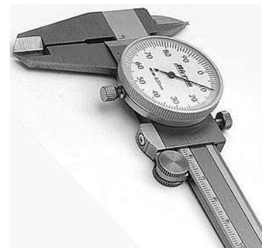
Рисунок 1 - Штангенциркуль со стрелкой на круговой шкале
