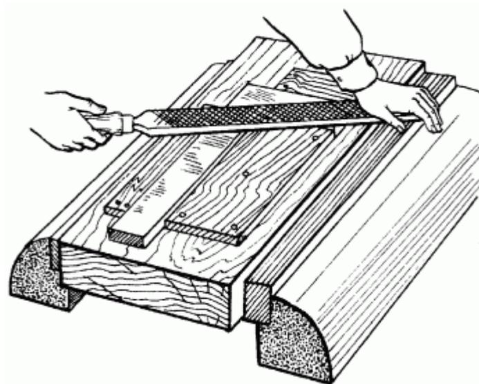
Рисунок 4 – Опиливание детали из тонкого металла.
