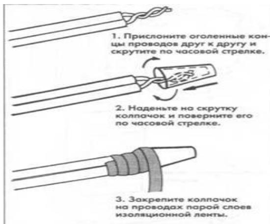
Рисунок 2 – Соединение жил кабеля
