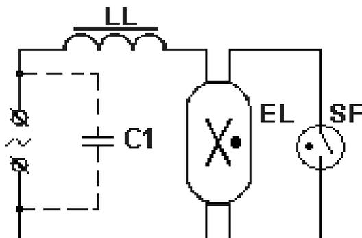
Рисунок 1- Схема включения люминесцентной лампы с дросселем
