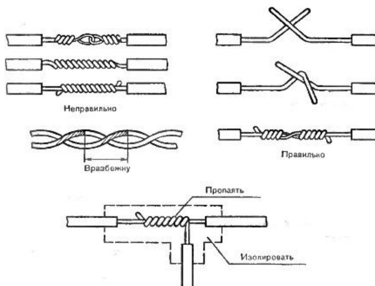
Рисунок 1 - Способы соединения и ответвления проводов скруткой
