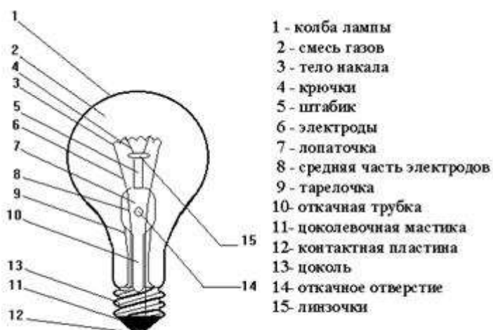
Рис. 3. Устройство лампы накаливания
