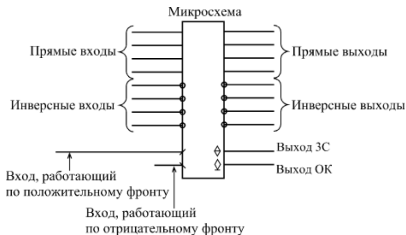
Рис. 2. Обозначение входов и выходов
