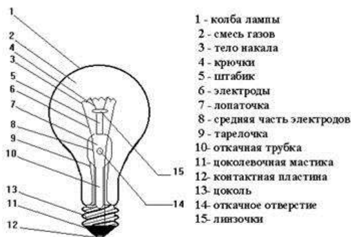
Рис. 3. Устройство лампы накаливания
