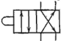
а) гидрораспределитель четырехлинейный двухпозиционный;
