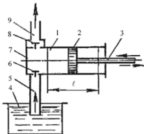
а) 2 - поршень, 1 - цилиндр, 7 -рабочая камера;
