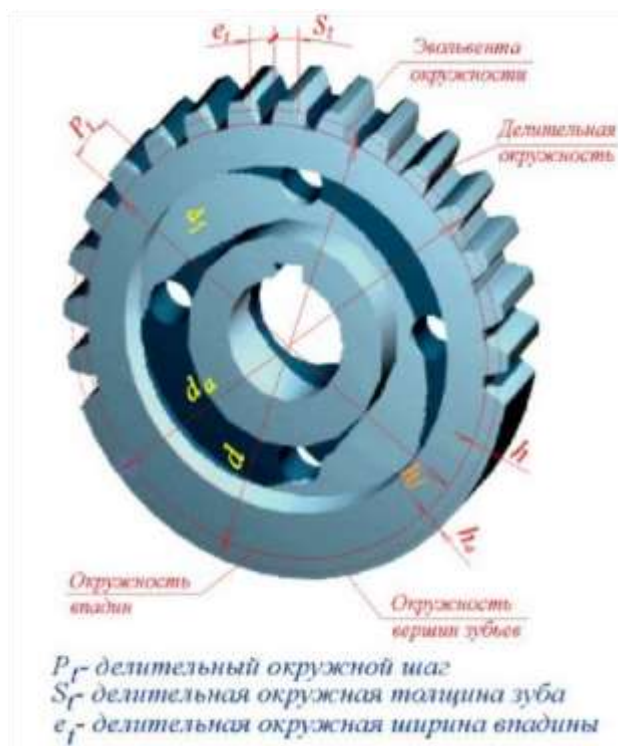
Рисунок 5. Геометрические параметры зубчатых колес
