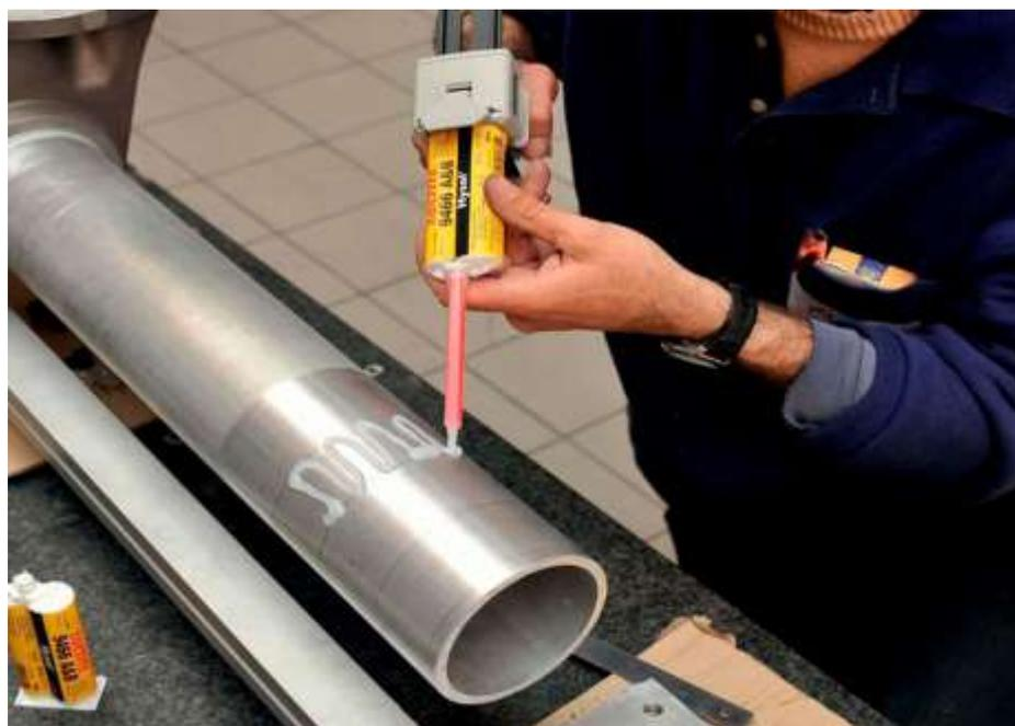
Рис. 4. Склеивание металла
