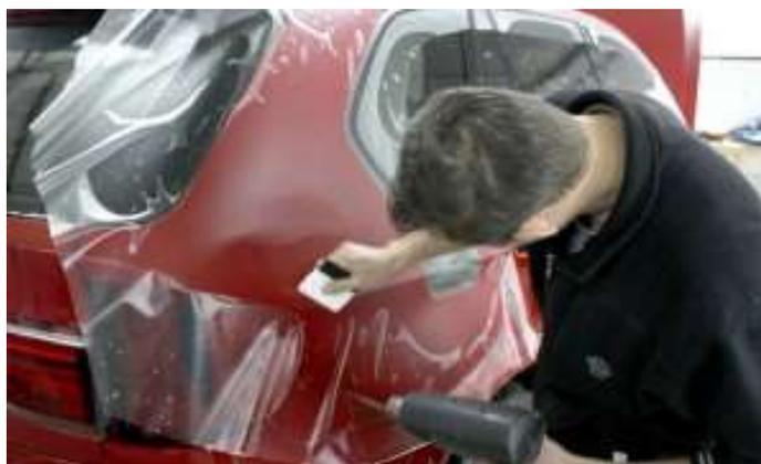
Рис. 2. Защитные пленки от коррозии
