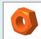
Пример условного обозначения гайки: исполнения 1; диаметром резьбы  $\varnothing = 10$  мм; с мелким шагом резьбы 1,25 мм; ГОСТ 5915-70. *Гайка M10x 1,25 ГОСТ 5915-70*
