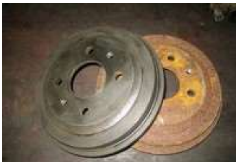
Рис.4. Фосфатирование стальных поверхностей
