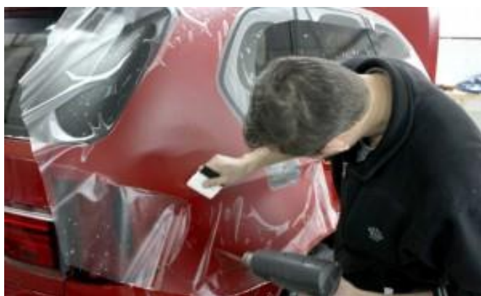
Рис. 2. Защитные пленки от коррозии
