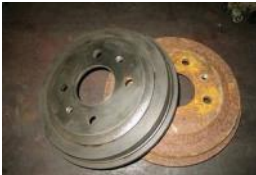
Рис.4. Фосфатирование стальных поверхностей
