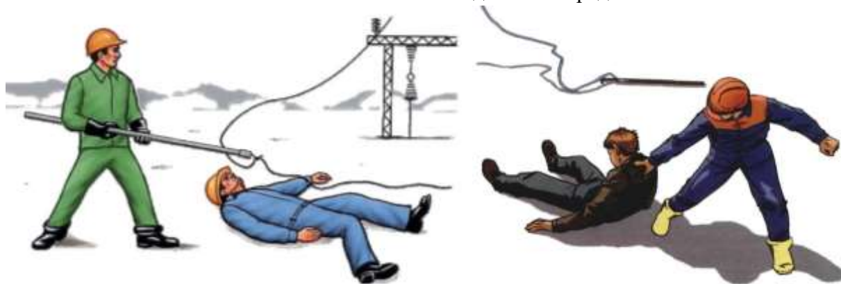
Рис. 3. Способы освобождения пострадавшего при напряжении выше 1000 В
