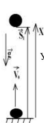
$$\vec{S}_1 = \frac{v^2 - v_0^2}{2\vec{g}} \quad \text{Проектируем: } S_1 = \frac{v^2 - v_0^2}{-2g}$$
