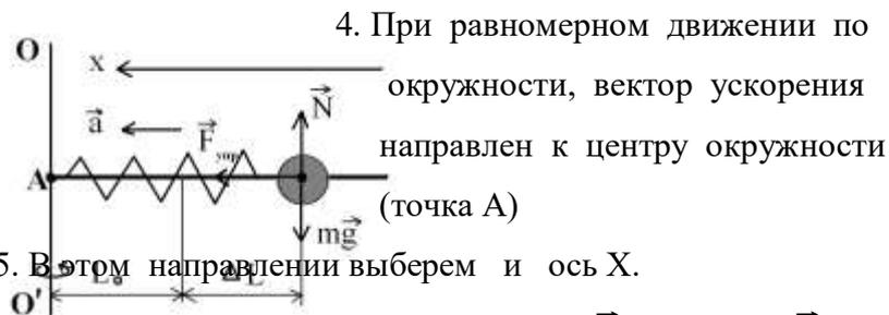
6. Второй закон Ньютона:  $m\vec{a} = \vec{N} + m\vec{g} + \vec{F}_{упр}$
