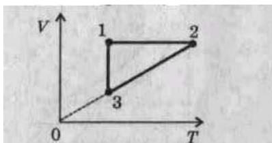
Постройте графики процесса, происходящего с идеальным газом (см. рисунок), в координатах  $p$ ,  $T$  и  $V$ ,  $T$ . Масса газа постоянная.
