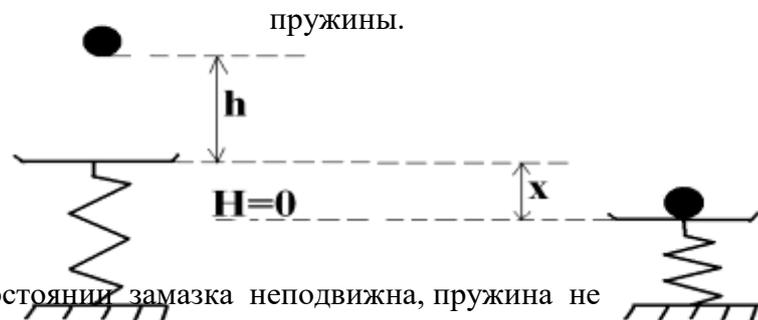
В первом состоянии замазка неподвижна, пружина не деформирована, но кусок замазки находится на высоте  $H$  от нулевого уровня. Энергия системы  $W_1 = mgH = mg(x + h)$
