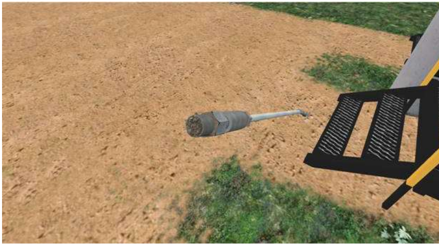
Рисунок 4. Установка "образцы свидетеле коррозии" (забитые песком)
