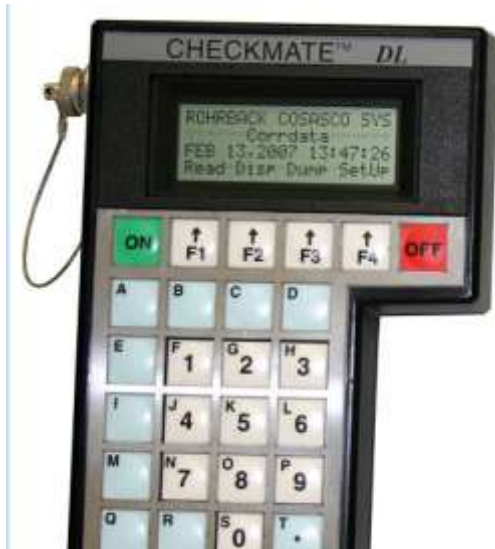
Рисунок 2. Считыватель показаний Microstg-a во взрывозащищенном кейсе
