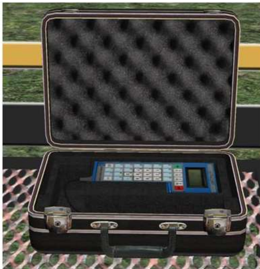
Рисунок 10. Считыватель показаний UltraCorr -а во взрывозащищенном кейсе
